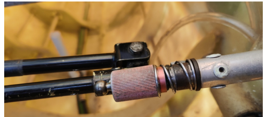
Foto van de losgekomen rolroeraansluiting.
